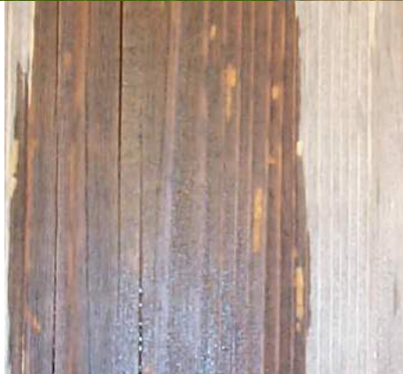
Bois résineux traité avec un produit solvanté
